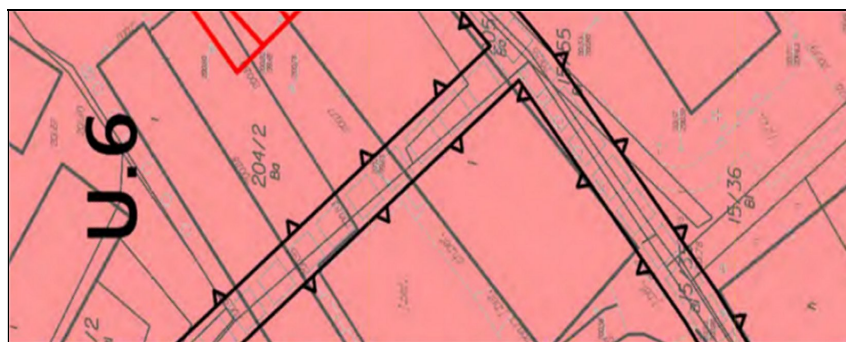
Ryc. 6. Przykład sposobu wyznaczenia nieprzekraczalnej linii zabudowy od strony wnętrza obszaru funkcjonalnego (W)
