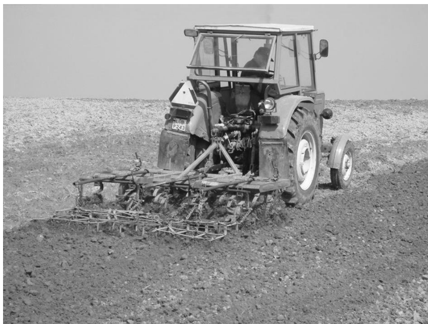
Fot. 1. Wykonywanie uprawki przedsiewnej (kultywator i brona średnia) Photo 1. Pre-sowing tillage operation (cultivator and harrow)
