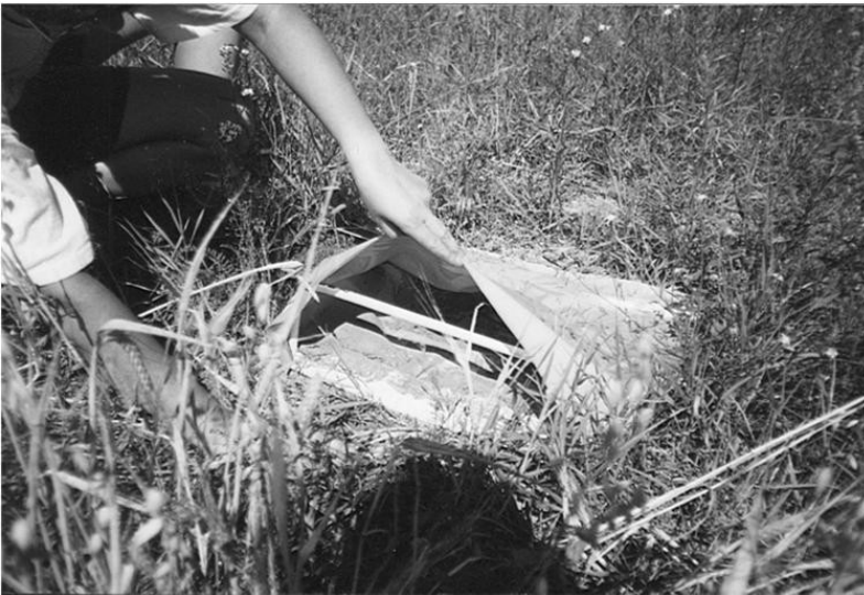
Fot. 1. Łapacz - zmodyfikowany worek Słupika Photo 1. Runoff collector - modified Słupik's bag
