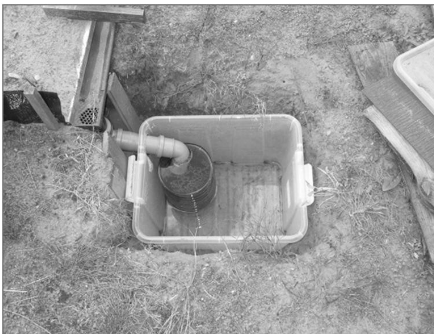
Fot. 2. Urządzenie zbierające spływ i erodowaną glebę Photo 2. Collector at runoff plot
