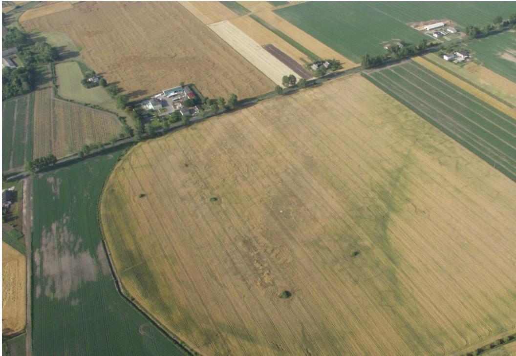
Ryc. 4. Przykład obiektu antropogenicznego (zakopana rura perforowana z XIX w. o średnicy około 15cm), który może być mylony z kopalną szczeliną mrozową
